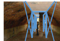
Stahlkonstruktion mit Schutzdach (ohne Sicherung der Tonröhren)
